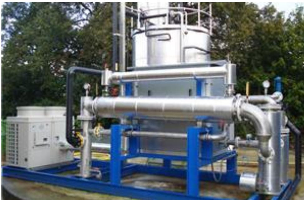
**Рисунок 6 – Биореактор технологии Shell-Paques**
